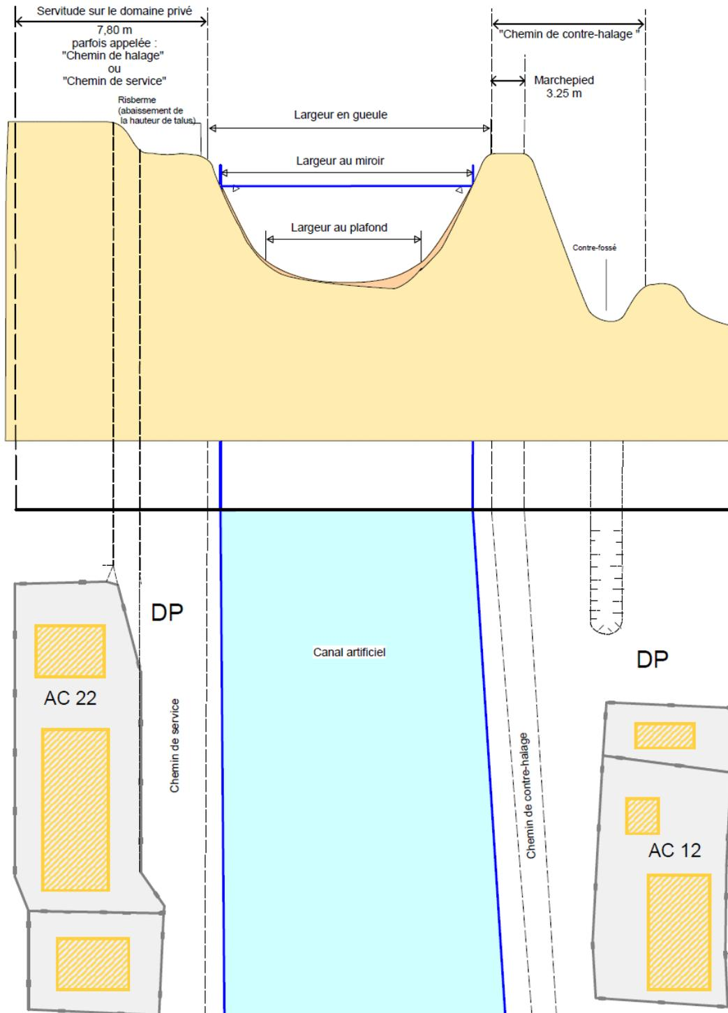
Les servitudes s'appliquent à partir de la largeur en gueule du canal, car le niveau de l'eau est susceptible de varier en fonction de l'exploitation de l'ouvrage autour d'un niveau d'exploitation couramment appelé « NNN » niveau normal de navigation, à partir de la largeur au miroir.
